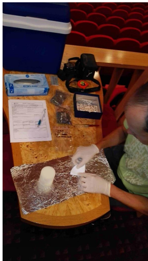
Obr. 16 a 17: Manipulace s filtry po odběru 1 - vyjmutí pinzetou a skládání filtru
