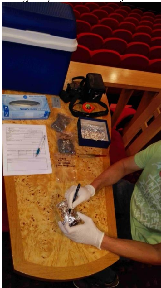
Obr. 18 a 19: Manipulace s filtry po odběru 2 - zabalení filtrů do fólie a označení vzorku
