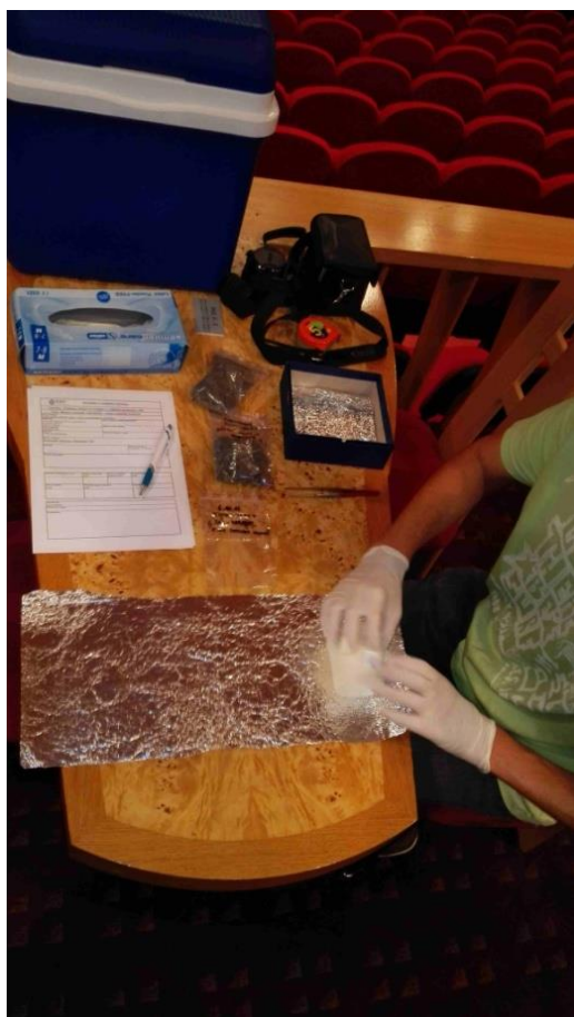
Obr. 18 a 19: Manipulace s filtry po odběru 2 - zabalení filtrů do fólie a označení vzorku
