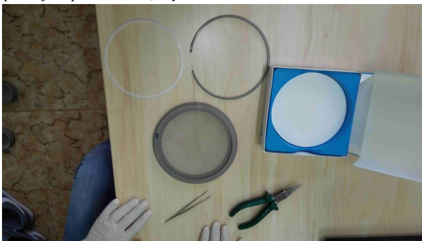
Obr. 11: Příprava před vložením filtru do objímky
