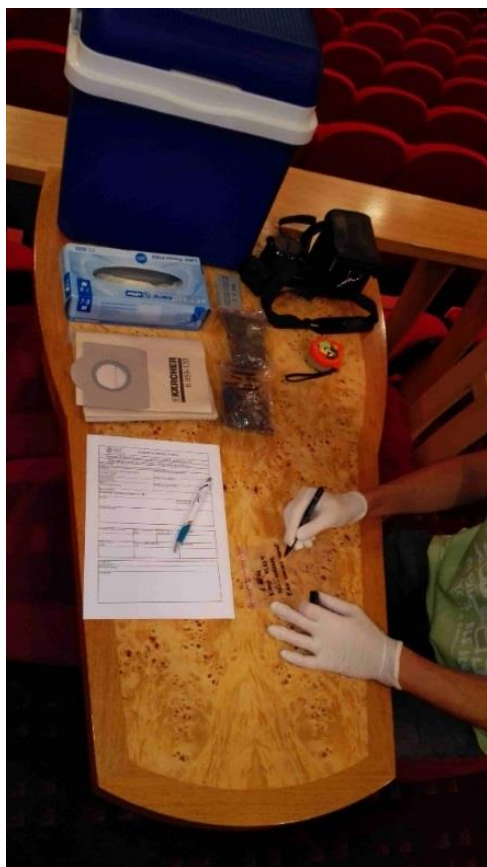
Obr. 20: Odběr prachu – popis vzorku na uzavíratelný sáček, do kterého je posléze vložen prach
