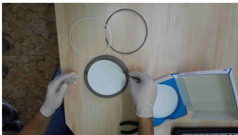
Obr. 12: Vložení filtru do objímky pinzetou
