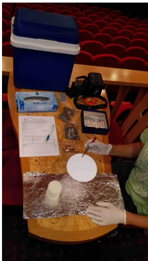
Obr. 16 a 17: Manipulace s filtry po odběru 1 - vyjmutí pinzetou a skládání filtru
