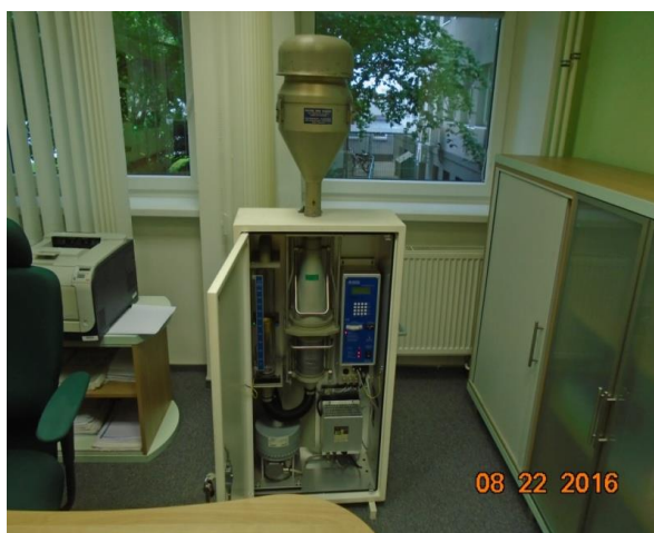
Obr. 2 a 3: Příklad měření přístroji HVS v kancelářích
